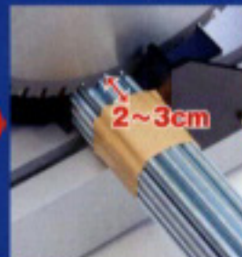
②「全ネジ」の切断位置は必ず「布粘着テープ」から2~3cmの位置で固定します。
