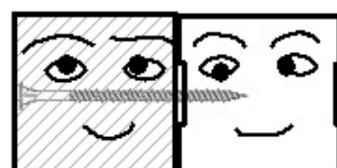
木スタッド+角スタッド “カクスタスクリュー串刺し工法”
