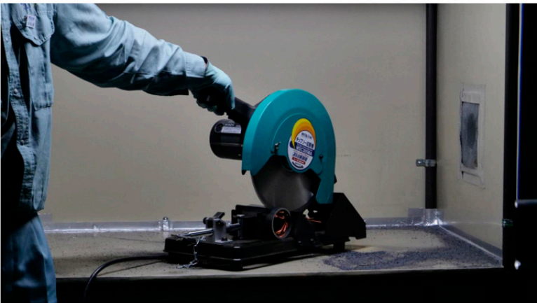
図 2. チップソーでの切断時 火花
