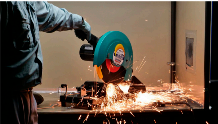
図 1. 切断砥石での切断時 火花
